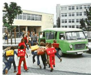
In die umlaufende Fensterfront sind z.T. Schiebefenster eingefügt. Die halbhohe Rückwand des Fahrerhauses gewährt den Fahrgästen einen freien Blick nach vorn. Die Hecktür ist für das Einladen des Gepäcks vorgesehen. Bei voller Personenzahl finden 385 kg Gepäck Aufnahme im rückwärtigen Teil des Innenraumes und unter der letzten Sitzbank. Während alle übrigen Versionen des Fiat 238 wahlweise mit 47 PS- oder 52 PS-Motor ausgerüstet sind, wird der Autobus nur mit 52 PS geliefert.
