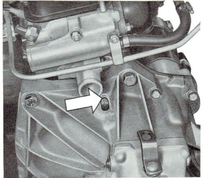
Abb. 138 - Überprüfung der Zündungseinstellung bei im Fahrzeug eingebautem Motor.
