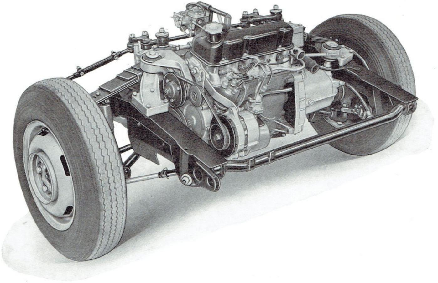
Abb. 86 - Vorderansicht des Hilfsrahmens mit Vorderrad- und Triebwerksaufhängung.
