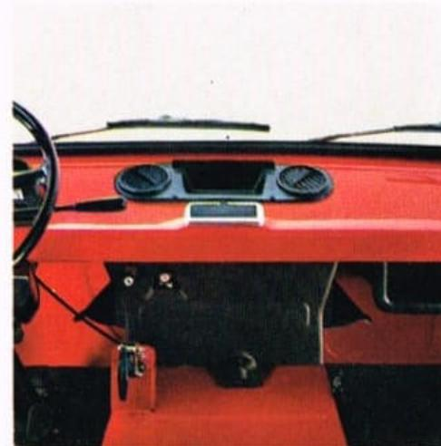
*Heizungs- und Lüftungsanlage mit stufenlos regelbarer Kalt- und Warmluftmenge. 1 Schlitzdüse mit 2 drehbaren Rosetten auf dem Armaturenbrett zum Klarhalten der Windschutzscheibe bei Frost und hoher Luftfeuchtigkeit. Außerdem Klappen an beiden Seiten des Heizkörpers, um kühle oder warme Luft in den Fußraum zu leiten. Hohe Wirksamkeit der Heizung auch bei niedrigen Außentemperaturen.*
