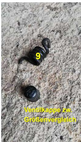
3. Das kleine Federchen (9): Es springt bei Demontage der Bremsenteile gerne mal durch die Gegend, wird dann bei der Remontage übersehen und lässt sich hinterher nicht mehr leicht zuordnen.
