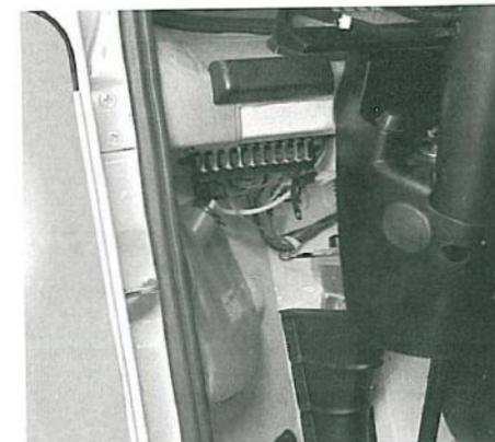
Sicherungskasten unter der Instrumententafel
