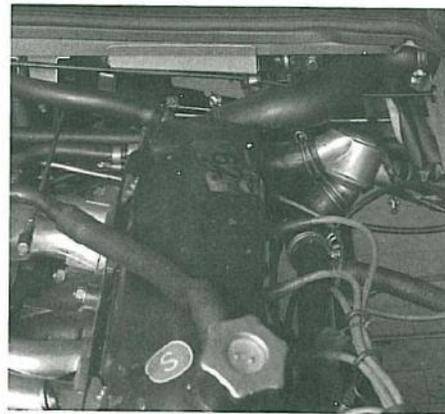
Thermostat und Verbindungsschlauch zum Saugkrümmer
