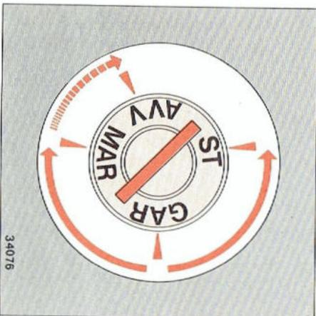
Bei Schaltschlüssel in Stellung **MAR** sind alle übrigen Stromkreise angeschlossen und zwar: Fernlicht mit Kontrolllampe, Spannungsregler, Erregerwicklung des Generators, Ladeanzeigeleuchte der Batterie, Kraftstoffstandanzeiger mit Reserveanzeige, Warnlampe für Motoröldruck,
