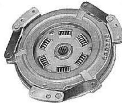
Abb. 57 - Kupplung während der Phase des Zerlegens.
