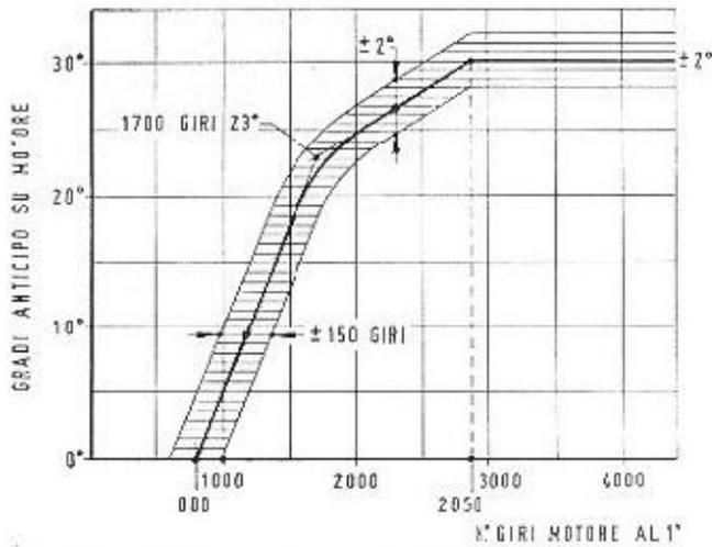
Abb. 138 - Diagramm der automatischen Zündverstellung.
